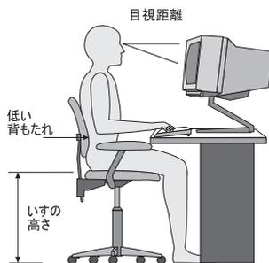
モニターは、画面の最上部が目の高さかそれより少し下になるように調節します。モニターは見やすい距離に置いてください。通常、利用者とモニターとの距離は 50 ～ 60 cm です。また、体をねじらなくても見えるような位置に置いてください。電話やマウスなど定期的に使用する他の機器も、手が届きやすい位置に置いてください。
