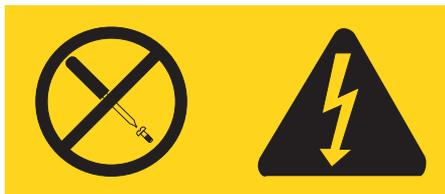
Tout composant portant cette étiquette présente un danger électrique, ainsi qu'un niveau de courant et d'énergie. Aucune pièce de ces composants n'est réparable. Si vous pensez qu'ils peuvent être à l'origine d'un incident, contactez un technicien de maintenance.
