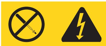
Във вътрешността на всеки компонент с този етикет има наличие на опасно напрежение, ток и високи енергийни нива. В този компонент няма части, които да изискват обслужване. Ако предполагате наличието на проблем с някоя от тези части, свържете се със сервизен специалист.
