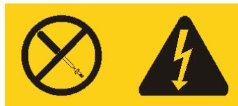
يوجد تيار كهربائي في منتهى الخطورة بداخل المكونات التي تم وضع هذه العلامة عليها. لا توجد أجزاء يمكن صيانتها داخل هذه المكونات. اذا كنت تشك في وجود مشكلة مع أي جزء من تلك الأجزاء، اتصل بفني الخدمة.
