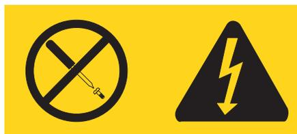
Quaisquer componentes que tenham esta etiqueta anexada, possuem interiormente voltagem perigosa, corrente e níveis de energia. Não existem peças no interior desses componentes que possam ser consertadas. Se você suspeitar de um problema com uma dessas peças, entre em contato com um técnico de serviço.
