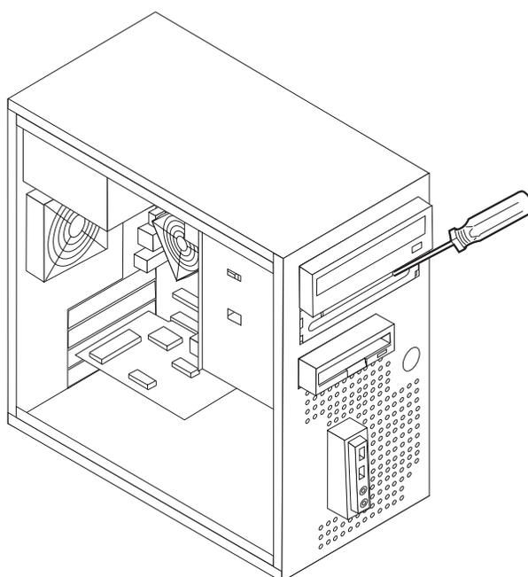
4. Retire el panel de plástico del marco biselado de la bahía 2 apretando las pestañas de plástico que fijan el panel en el interior del marco biselado.
