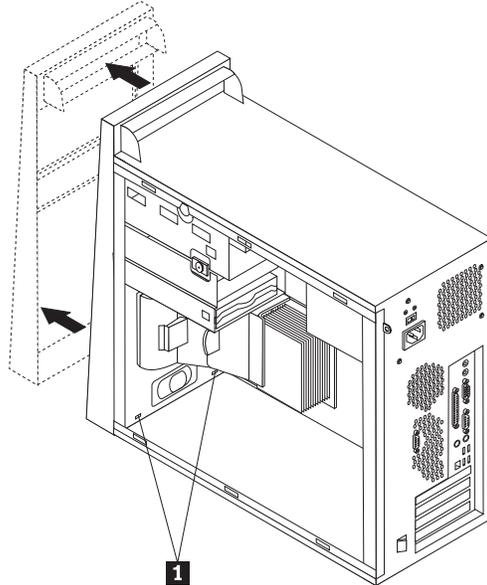
3. Entfernen Sie die antistatische Abschirmung von der Laufwerkposition, indem Sie sie mit einem Schlitzschraubendreher vorsichtig lösen.
