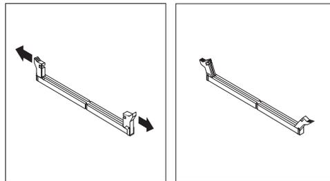
4. Vergewissern Sie sich, dass die Kerbe **1** am Speichermodul genau an der Anschlussmarkierung **2** auf der Systemplatine ausgerichtet ist. Drücken Sie das Speichermodul gerade nach unten in den Steckplatz, bis sich die Halteklammern schließen.
