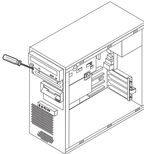
4. Entfernen Sie die Kunststoffabdeckung der Frontblende für Position 2, indem Sie auf die Plastikzungen drücken, die die Abdeckung in der Frontblende sichern.
