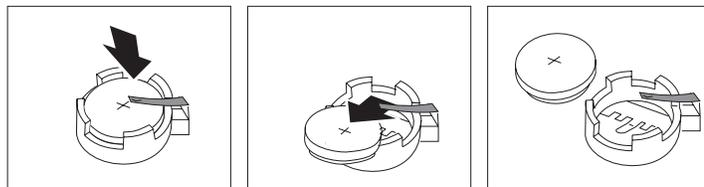
6. Installieren Sie die neue Batterie.
