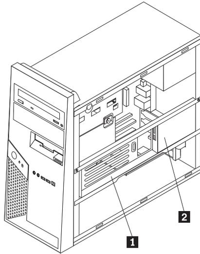
**Anmerkung:** In der Halterung sind zwei Laufwerkpositionen vorhanden. Aufgrund thermischer Einschränkungen kann jedoch nur in Position **2** an der Rückseite des Gehäuses ein Festplattenlaufwerk installiert werden.
