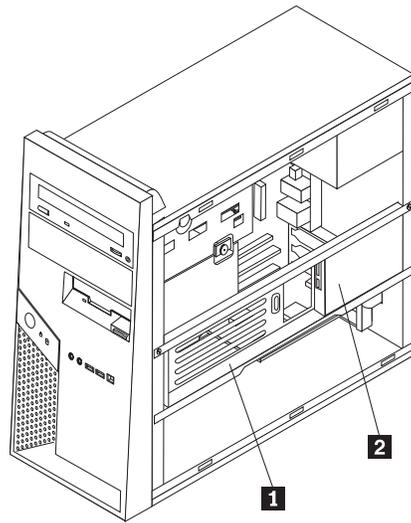
**Nota:** Parece que hay dos bahías de unidades en la pieza de sujeción. Sin embargo, debido a restricciones térmicas, sólo se puede utilizar la bahía **2** de la parte posterior del chasis para instalar una unidad de disco duro.
