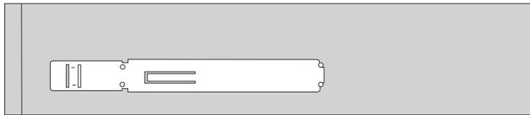
7. En el caso de una unidad de 3,5 pulgadas, instale la unidad en la pieza de sujeción adaptadora universal de 5,25 a 3,5 pulgadas.
