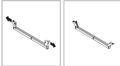
4. Asegúrese de que la muesca **1** del módulo de memoria esté alineada correctamente con la ranura **2** del conector de la placa del sistema. Presione el módulo de memoria hacia abajo y recto dentro del conector hasta que se cierren los clips de sujeción.
