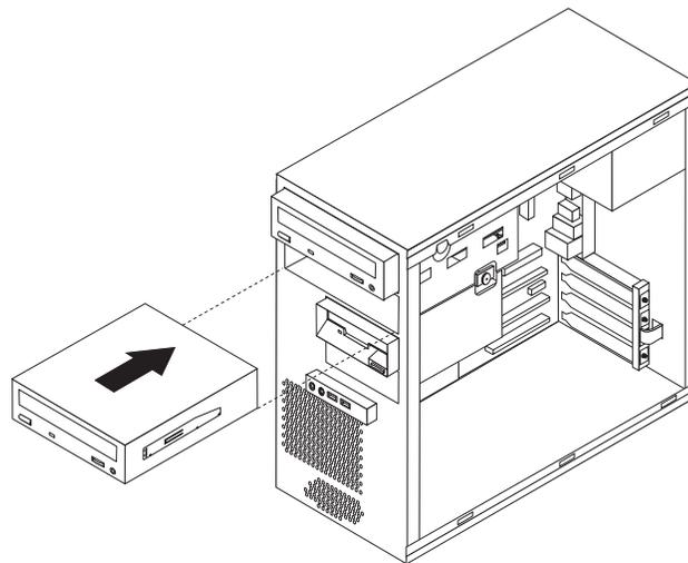
9. Instale el marco biselado frontal alineando las pestañas de plástico de la parte inferior del marco biselado con los orificios correspondientes del chasis hasta que encaje en su posición.
