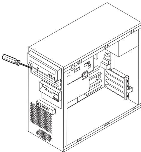
4. Retire el panel de plástico del marco biselado de la bahía 2 apretando las pestañas de plástico que fijan el panel en el interior del marco biselado.
