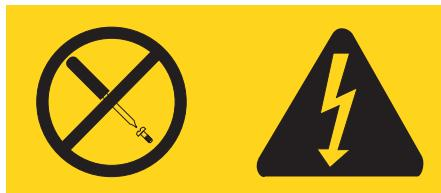
Unutar svake komponente na kojoj se nalazi ovakva naljepnica su prisutne rizične razine napona, električnog toka i energije. Unutar tih komponenti nema dijelova koji se mogu servisirati. Ako sumnjate da postoji problem s nekim od tih dijelova, obratite se tehničaru u servisu.
