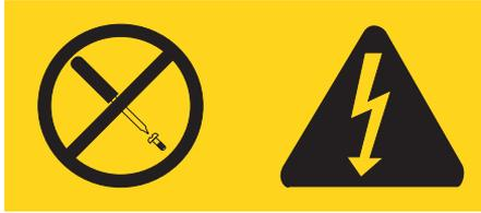
Les composants portant cette étiquette présentent un danger électrique. Aucune pièce de ces composants n'est réparable. Si vous pensez qu'ils peuvent être à l'origine d'un incident, contactez un technicien de maintenance.
