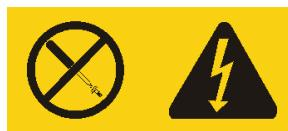
توجد مستويات القدرة والتيار والجهد الكهربائي داخل أي مكون يوجد به هذه العلامة المميزة. لا توجد أجزاء يمكن صيانتها داخل هذه المكونات. إذا كنت تعتقد أن هناك مشكلة في أحد هذه الأجزاء، اتصل بالمسئول عن تقديم الخدمة.
