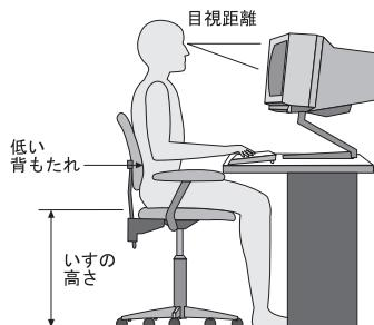
モニターは、画面の最上部が目の高さかそれより少し下になるように調節します。モニターは見やすい距離に置いてください。通常、利用者とモニターとの距離は 50 ~ 60 cm です。また、体をねじらなくても見えるような位置に置いてください。電話やマウスなど定期的に使用する他の装置も、手が届きやすい位置に置いてください。
