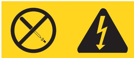
위와 같은 라벨이 부착되어 있는 모든 부품에는 인체에 위험을 주는 전압이나 전하량 및 에너지 수준이 존재합니다. 이러한 부품의 내부에는 수리할 수 있는 부분이 없습니다. 위와 같은 라벨이 부착된 부품의 고장이 의심스러운 경우, 서비스 센터에 연락하십시오.
