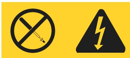
危险的电压、电流和能源级别会在任何贴有该标签的组件中存在。这些组件中没有可维护的部件。如果您怀疑这些部件中的某个有问题，请联系技术服务人员。
