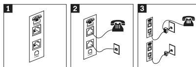
**1** 该图显示计算机后部两个用于安装调制解调器的接口。
