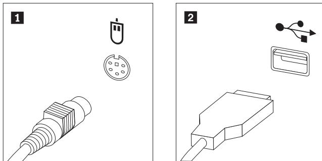
4. 拔掉電腦上的故障滑鼠接線。
