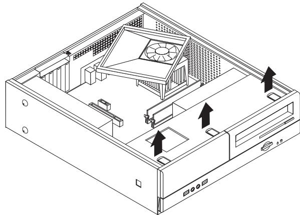
3. 固定磁碟機機槽組件的機箱前端有兩個螺絲，請將螺絲卸下。
