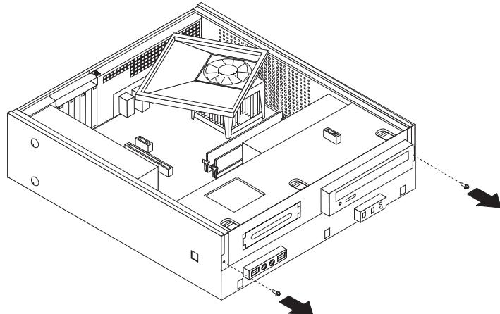
4. 將磁碟機機槽組件向前滑動，直到磁碟機機槽組件與機箱兩側的兩個插槽對齊，然後拔掉主機板上的磁碟機接線。接著將磁碟機機槽組件向上旋轉，將其整個與電腦分離。
