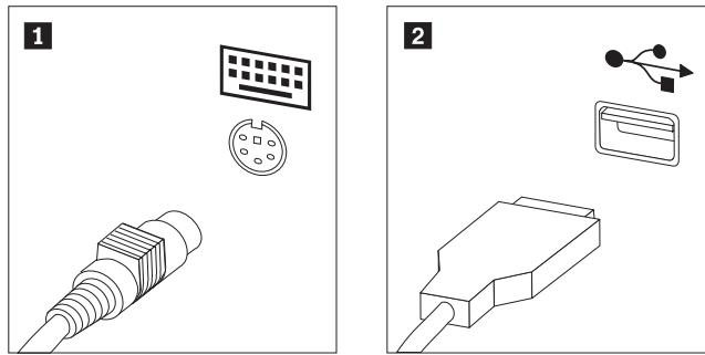
4. 拔掉電腦上的故障鍵盤接線。
