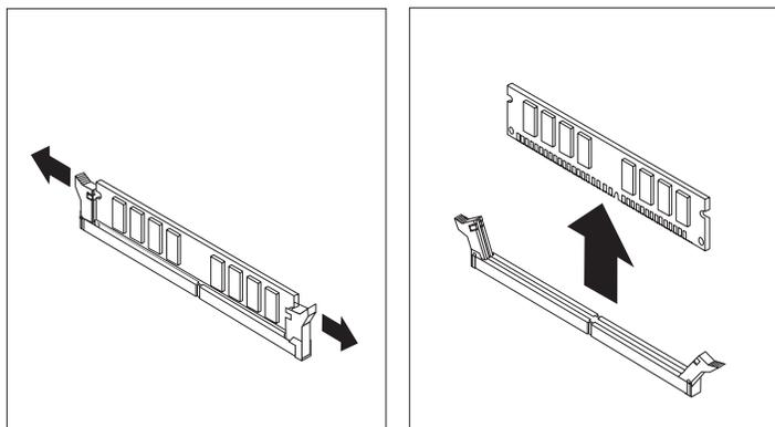
3. 新しいメモリー・モジュールをメモリー・コネクタの上に置きます。このメモリー・モジュールの切り欠き **1** とシステム・ボード上のコネクタ・キー **2** の位置を正確に合わせます。固定クリップが閉じるまで、メモリー・モジュールをメモリー・コネクタに押し込みます。
