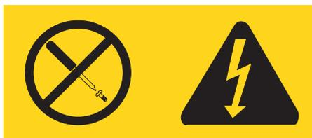
Estão presentes tensão, corrente e níveis eléctricos perigosos dentro de qualquer peça que tenha esta etiqueta afixada. Não existem peças passíveis de assistência dentro destas peças. Se suspeitar de algum problema numa destas peças, contacte um técnico de assistência.
