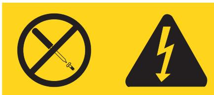
Estão presentes tensão, corrente e níveis eléctricos perigosos dentro de qualquer peça que tenha esta etiqueta afixada. Não existem peças passíveis de assistência dentro destes componentes. Se suspeitar de algum problema num destes componentes, contacte um técnico da assistência.
