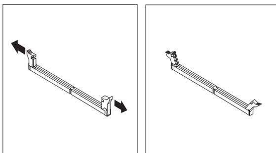
5. Certifique-se de que o entalhe **1** no módulo de memória fique corretamente alinhado com a chave do conector **2** na placa-mãe. Empurre o módulo de memória para baixo, de forma alinhada ao conector de memória, até que os cliques de retenção sejam fechados.
