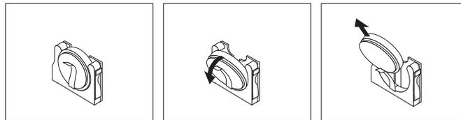
7. Instale a nova bateria, utilizando a seguinte ilustração.
