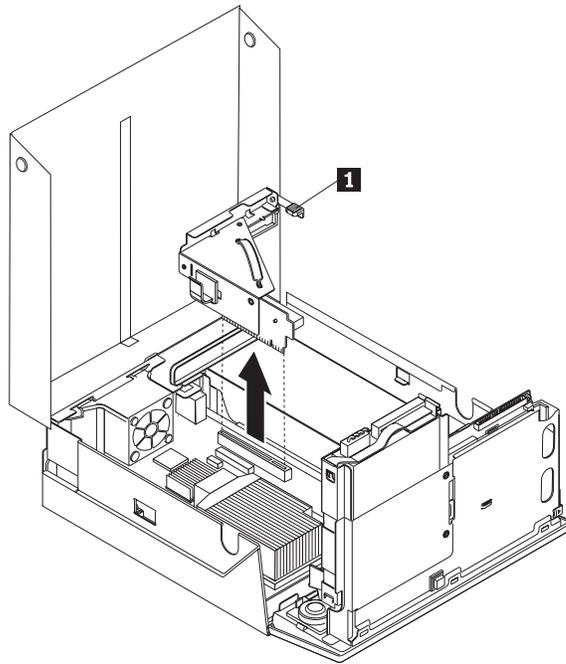
6. Movimente a trava do adaptador **1** para cima e então remova a tampa do conector de expansão.
