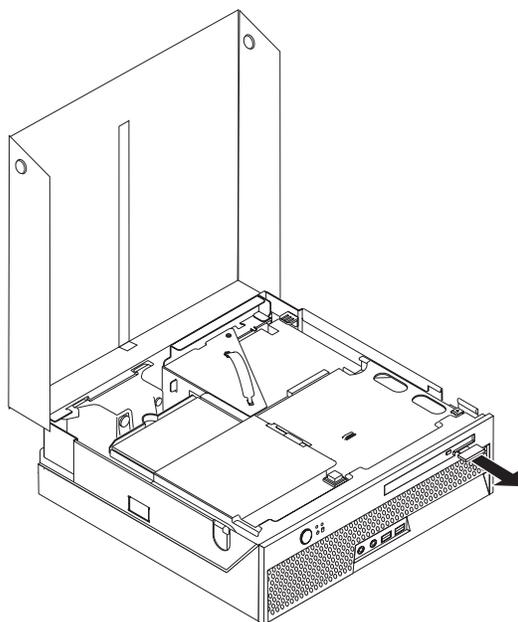
4. Deslize a unidade óptica para fora da parte frontal do computador.
