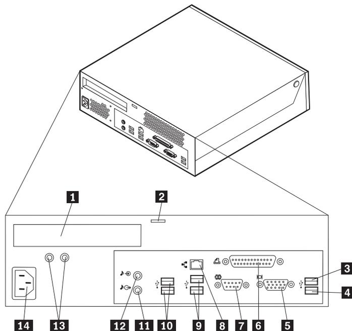
**1** Conector de adaptador PCI
