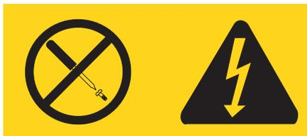
Quaisquer componentes que tenham esta etiqueta anexada, possuem interiormente voltagem perigosa, corrente e níveis de energia. Não existem peças no interior desses componentes que possam ser consertadas. Se você suspeitar de algum problema com uma dessas peças, entre em contato com um técnico de serviço.
