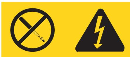
Unutar svake komponente na kojoj se nalazi ovakva naljepnica su prisutne rizične razine napona, električnog toka i energije. Unutar tih komponenti nema dijelova koji se mogu servisirati. Ako sumnjate da postoji problem s nekim od tih dijelova, obratite se tehničaru u servisu.
