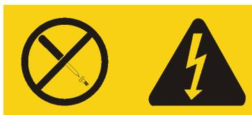
يوجد تيار كهربائي في منتهى الخطورة بداخل المكونات التي تم وضع هذه العلامة عليها. لا توجد أجزاء يمكن صيانتها داخل هذه المكونات. إذا كنت تعتقد أن هناك مشكلة في أحد هذه الأجزاء، اتصل بالمسئول عن تقديم الخدمة.
