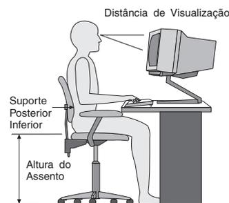
Ajuste o monitor de forma que a parte superior do teclado esteja no nível de seus olhos ou um pouco abaixo. Coloque o monitor a uma distância de visualização confortável, que geralmente varia de 51 a 61 cm (20 a 24 polegadas) e posicione-o de forma que possa vê-lo sem ter de torcer seu corpo. Posicione, também, outros equipamentos utilizados com frequência, como o telefone ou um mouse, em local de fácil acesso.
