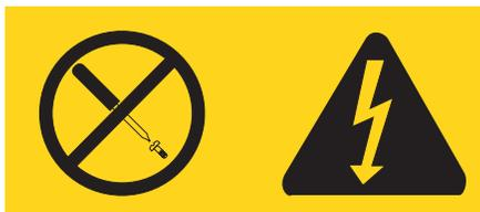
I livelli di energia, di tensione e corrente sono presenti all'interno dei componenti dotati di questa etichetta allegata. All'interno di tali componenti non vi sono parti su cui effettuare l'assistenza tecnica. Se si sospetta di un problema relativo ad uno di questi componenti, contattare l'assistenza tecnica.
