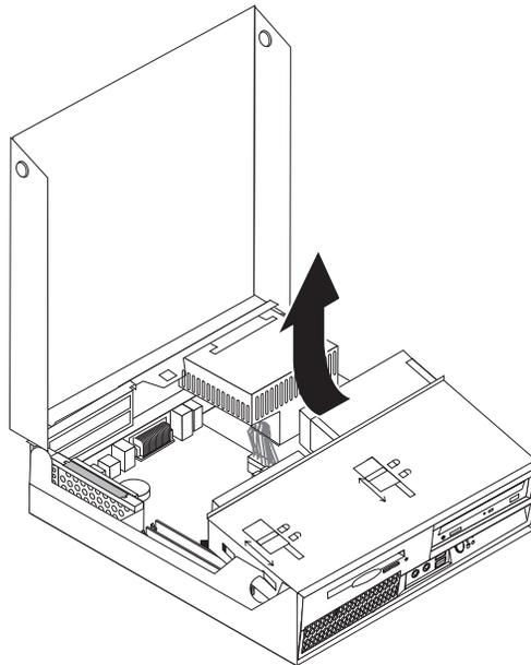
4. Tout en maintenant en place la partie arrière du boîtier de l'ordinateur, tirez sur la poignée afin de retirer le connecteur de bus et les cartes PCI installés.
