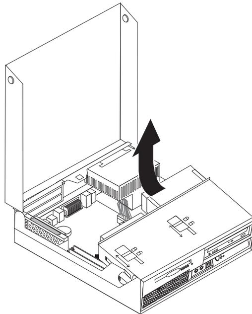
3. Si une unité de disque optique est installée, déconnectez le câble d'interface de l'unité pour accéder aux câbles de l'unité de disque dur.
