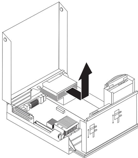
8. Installez le nouveau bloc d'alimentation dans le boîtier en vous assurant que les trous des vis du bloc d'alimentation sont alignés sur ceux du boîtier.
