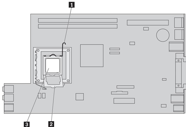
**Remarque :** Vous devez apercevoir un élément plastique de couleur noire qui recouvre le dispositif de retenue du microprocesseur afin de protéger le connecteur sur la nouvelle carte mère. Lorsque le microprocesseur est en position verrouillée, retirez l'élément en plastique noir. Placez-le sur le crochet de retenue du microprocesseur de la carte mère défectueuse.
