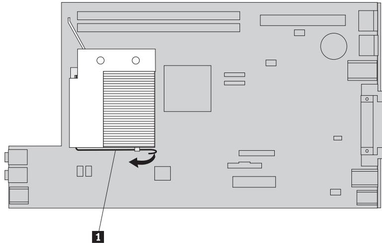
11. Pour retirer le microprocesseur de la carte mère défectueuse, soulevez la languette **1** qui maintient le microprocesseur **3**, puis faites pivoter le dispositif de retenue du microprocesseur **2** pour l'ouvrir complètement.
