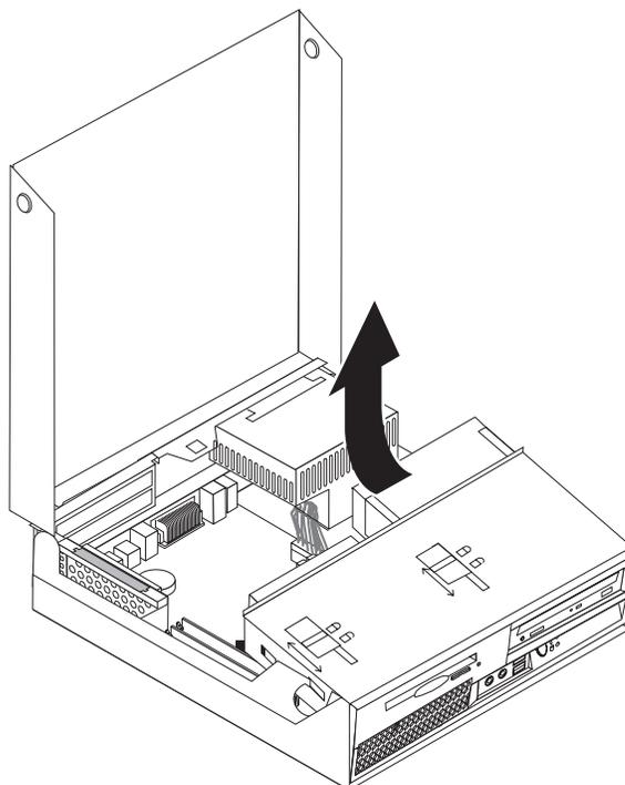
3. Déconnectez le câble d'interface et le cordon d'alimentation à l'arrière de l'unité de disque optique.
