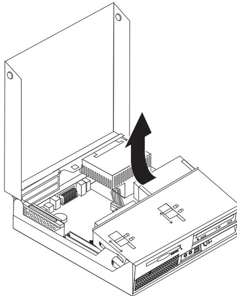
4. Слегка нажимая на заднюю часть рамы компьютера, потяните за ручку и вытащите карту-адаптер PCI Riser и все установленные контроллеры.
