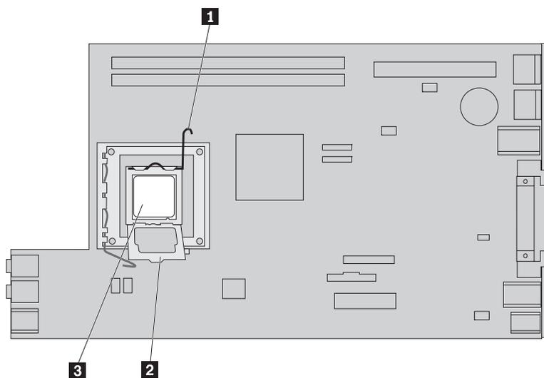
12. Потяните микропроцессор вверх и вытащите его из гнезда.
