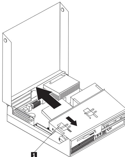
5. Отсоедините от дисковода плоский кабель (на задней части дисковода).
