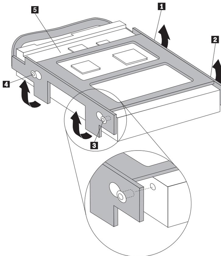
8. Установите жесткий диск и крепежную скобку в отсек дисководов.
