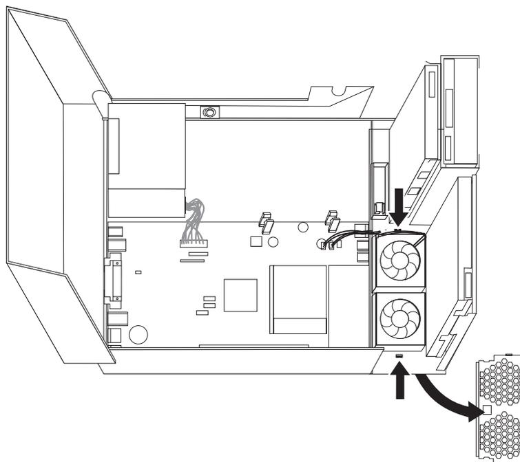
6. Снимите вентилятор, освободив язычки (смотрите рисунок).
