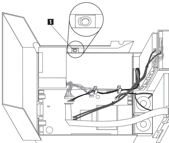
6. Вставьте нижнюю часть нового динамика в металлические петельки и поверните верхнюю часть динамика внутрь так, чтобы динамик зафиксировался в нужном положении.
