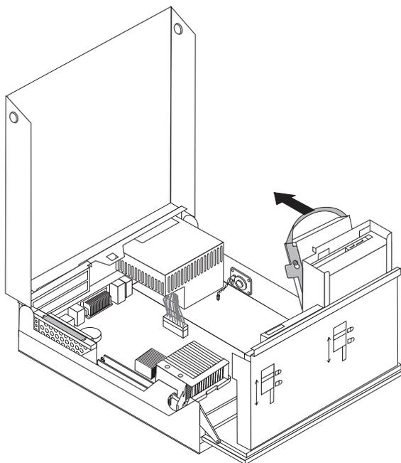
6. Вытащите неисправный жесткий диск из крепежных скобок; для этого нужно отогнуть скобки.
