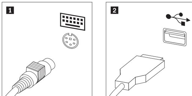
4. Отсоедините от компьютера кабель неисправной клавиатуры.
