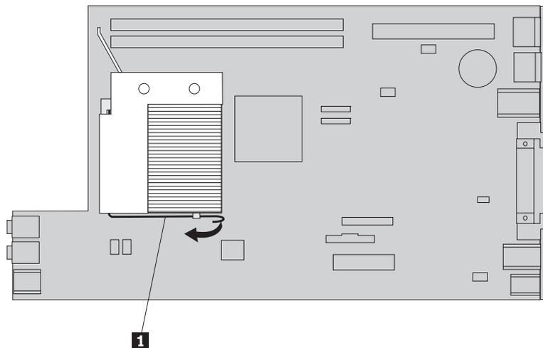
11. Если нужно снять микропроцессор с неисправной материнской платы, то потяните за рычаг **1**, крепящий микропроцессор **3**, а затем поверните до упора фиксатор микропроцессора **2**.
