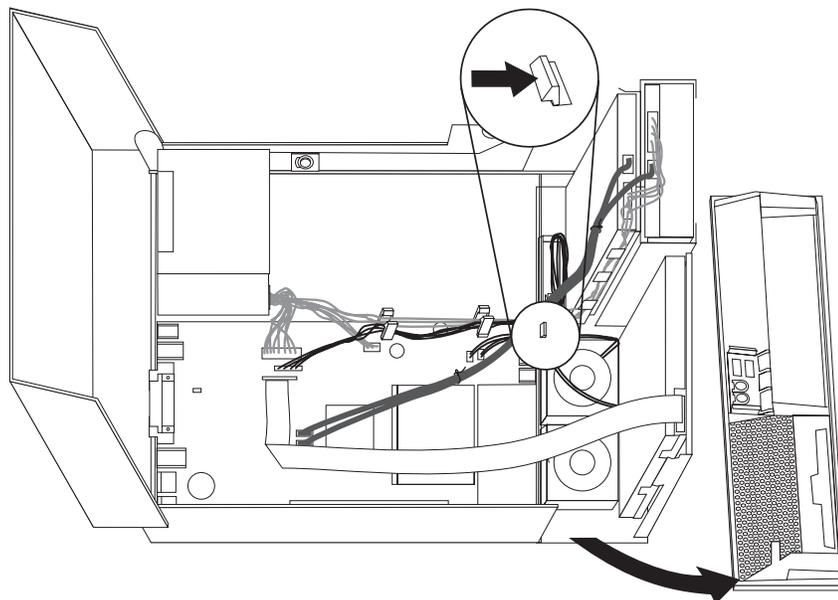
5. Снимите пластмассовую вставку сзади панели, освободив язычки (смотрите рисунок).
