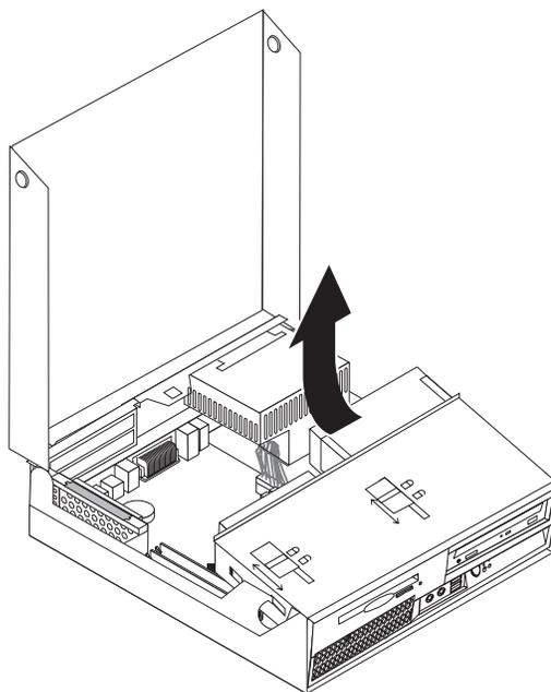
3. Если в компьютере установлен дисковод оптических дисков, то отсоедините от него сигнальный кабель, чтобы получить доступ к кабелям жесткого диска.
