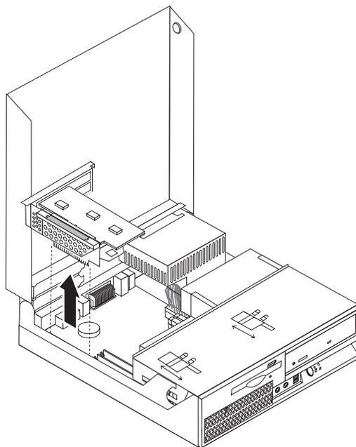
3. Откройте защелку контроллера и снимите неисправный контроллер.
