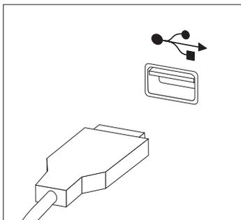
4. Отсоедините от компьютера кабель неисправной мыши.
