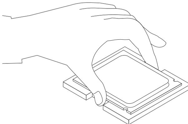
16. Опустите фиксатор микропроцессора **2**, а затем опустите рычаг **1**, закрепляющий фиксатор. Убедитесь, что рычаг надежно защелкнулся в нужном положении.
