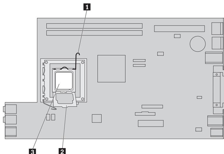
**Примечание:** На новой материнской плате фиксатор микропроцессора будет закрыт черной пластмассовой пленкой, защищающей гнездо микропроцессора. После того, как микропроцессор зафиксирован в нужном положении, снимите эту пленку. Закройте черной пластмассовой пленкой фиксатор микропроцессора на неисправной материнской плате.
