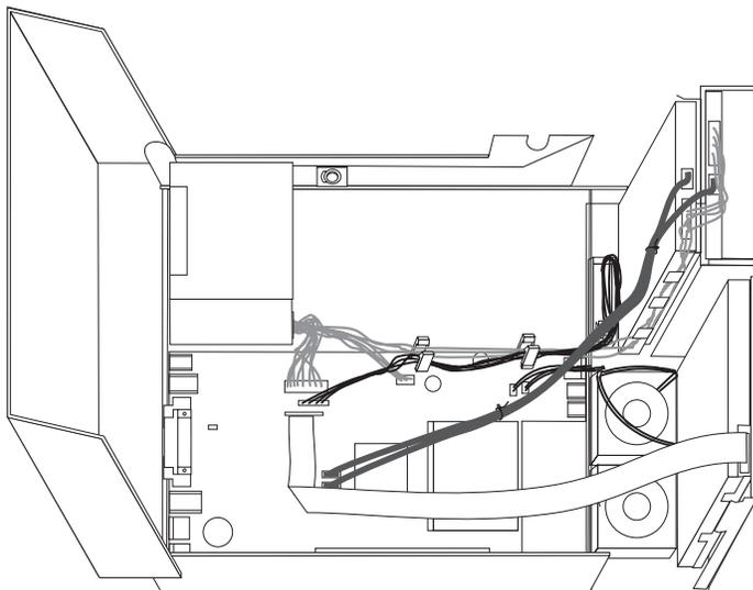
3. Опустите отсек дисководов и закройте замки дисководов. Иначе вы не сможете закрыть кожух компьютера.
