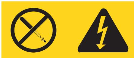
Quaisquer componentes que tenham esta etiqueta anexada, possuem interiormente voltagem perigosa, corrente e níveis de energia. Não existem peças no interior desses componentes que possam ser consertadas. Se você suspeitar de algum problema com uma dessas peças, entre em contato com um técnico de serviço.
