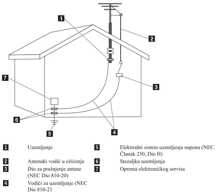
Slika 1. Pravilno uzemljenje kabla
