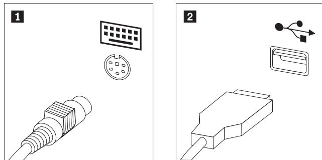
3. 請將滑鼠接線連接到適當的滑鼠接頭，可能是標準的滑鼠接頭 **1** 或「廣用序列匯流排 (USB)」接頭 **2**。
