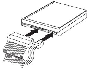
Figure 16. Connexion d'une unité de disque dur ATA parallèle
