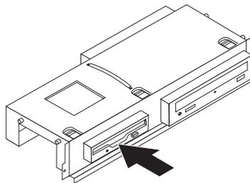
Figure 26. Installation de la nouvelle unité de disquette
