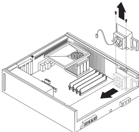
Figure 32. Retrait du bloc de ventilation du système
