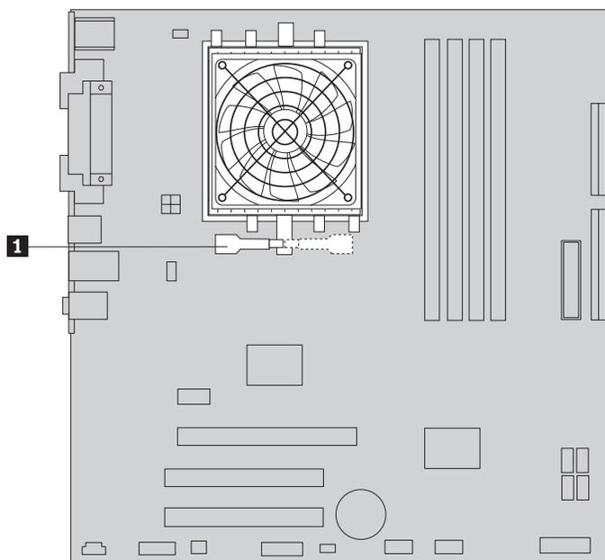
Figure 30. Retrait du dissipateur thermique
