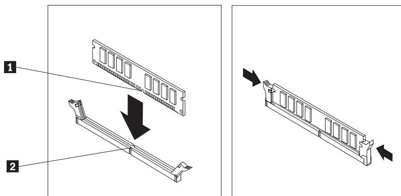
Figure 34. Installation du module de mémoire
