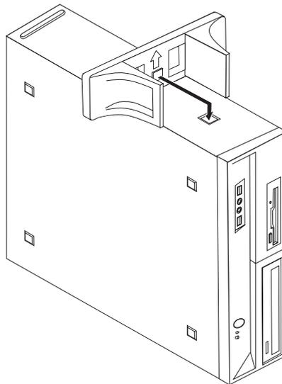
3. Faites pivoter le socle d'installation verticale vers l'avant de l'ordinateur jusqu'à ce qu'il s'enclenche en place.
