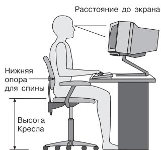
Установите монитор так, чтобы верх экрана был на уровне глаз или немного ниже. Расположите монитор на удобном расстоянии (50-60 см от глаз) так, чтобы при взгляде на экран не приходилось поворачиваться. Прочее оборудование, которым вы постоянно пользуетесь (например, телефон или мышь), также должно находиться под рукой.
