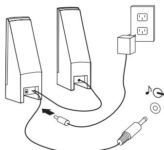
a. 如有必要，请连接两个扬声器之间的电缆。在某些扬声器上，该电缆是固定连接的。
