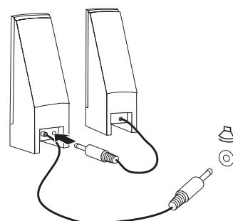
a. 如有必要，请连接两个扬声器之间的电缆。在某些扬声器上，该电缆是固定连接的。
