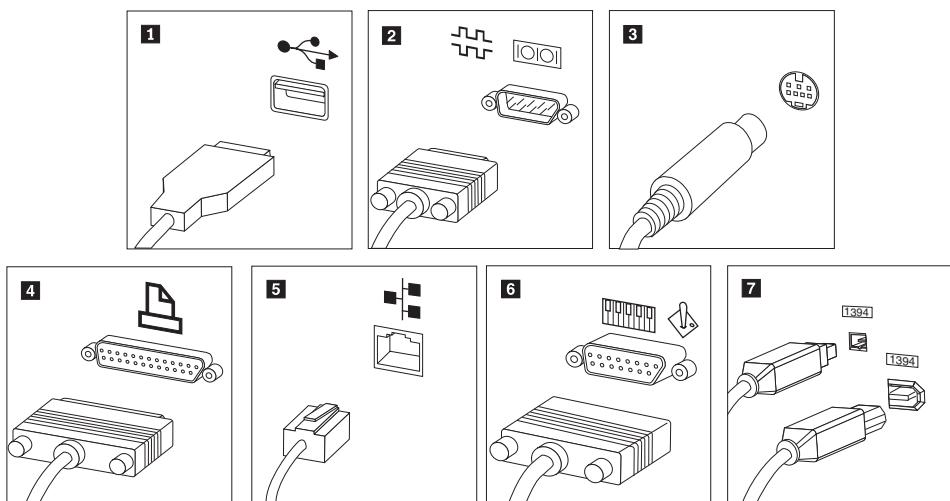
**1** USB 接口 此接口用于连接需要 USB 连接的设备，如键盘、鼠标、扫描仪、打印机或个人数字助理（PDA）。
