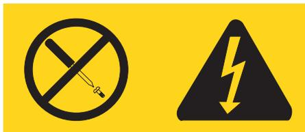
Les composants portant cette étiquette présentent un danger électrique. Aucune pièce de ces composants n'est réparable. Si vous pensez qu'ils peuvent être à l'origine d'un incident, contactez un technicien de maintenance.
