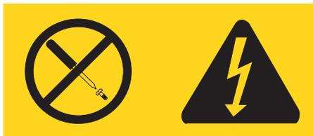
En el interior de los componentes que tienen pegada esta etiqueta existen niveles de voltaje, corriente y energía que son peligrosos. Dentro de estos componentes no existe ninguna pieza que requiera mantenimiento. Si sospecha que puede haber un problema en una de estas piezas, póngase en contacto con un técnico de servicio.
