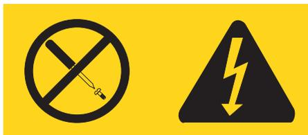
Quaisquer componentes que tenham esta etiqueta anexada, possuem interiormente níveis de energia, voltagem e correntes perigosos. Não existem peças no interior desses componentes que possam ser consertadas. Se você suspeitar de algum problema com uma dessas peças, entre em contato com um técnico de serviço.
