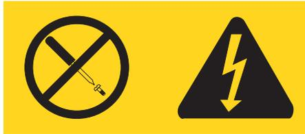
任何贴有此标签的组件内都有危险的电压、电流和能量。这些组件内没有可维修的部件。如果您怀疑某个部件有问题，请与技术服务人员联系。
