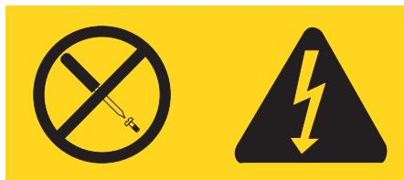
위와 같은 레이블이 부착되어 있는 모든 부품에는 인체에 위험을 주는 전압이나 전하량 및 에너지 수준이 존재합니다. 이러한 부품의 내부에는 사용자가 수리할 수 있는 부분이 없습니다. 위와 같은 레이블이 부착된 부품의 고장이 의심스러운 경우, 서비스 센터에 문의하십시오.
