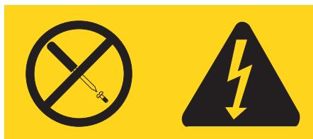
В усіх компонентах, на які нанесено таку позначку, є небезпечна напруга, сила струму або рівень енергії. Усередині цих компонентів немає елементів, які можна обслуговувати. Якщо є підо年之ри на несправність одного з цих компонентів, зверніться до спеціаліста з обслуговування обладнання.
