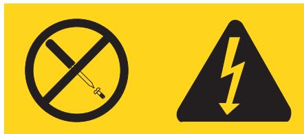
В усіх компонентах, на які нанесено таку позначку, є небезпечна напруга, сила струму або рівень енергії. Усередині цих компонентів немає елементів, які можна обслуговувати. Якщо є підоози на несправність одного з цих компонентів, зверніться до спеціаліста з обслуговування обладнання.
