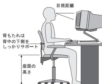
モニターは、画面の上部が目の高さ、またはそれよりわずかに低い位置にくるように調整します。モニターは、快適な目視距離（通常 51 から 61 cm）を設けて、身体をねじらなくても見える位置に置きます。また、電話機やマウスなど、恒常的に使用するその他の機器も、簡単に手が届く場所に配置します。
