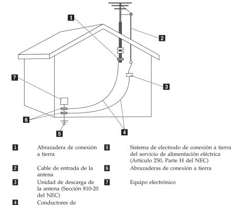
Figura 1. Conexión a tierra correcta del cable
