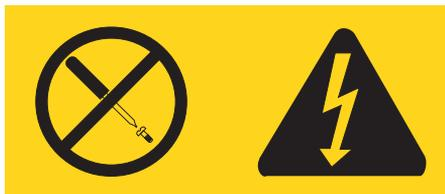
I livelli di energia, di tensione e corrente sono presenti all'interno dei componenti dotati di questa etichetta allegata. All'interno dell'unità non vi sono parti su cui effettuare l'assistenza tecnica. Se si sospetta di un problema relativo ad uno di questi componenti, contattare l'assistenza tecnica.
