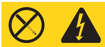
Във вътрешността на всеки компонент с този етикет има наличие на опасно напрежение, ток и високи енергийни нива. В този компонент няма части, които да изискват обслужване. Ако предполагате наличието на проблем с някоя от тези части, свържете се със сервизен специалист.
