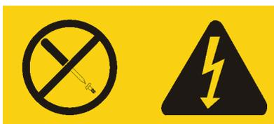
يوجد تيار كهربائي في منتهى الخطورة بداخل المكونات التي تم وضع هذه العلامة عليها. لا توجد أجزاء يمكن صيانتها داخل تلك المكونات. اذا كنت تشك في وجود مشكلة في أحد تلك الأجزاء، اتصل بفني الخدمة.
