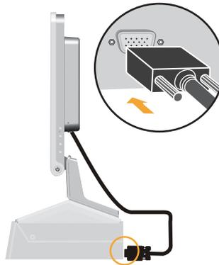
3. Insira o cabo de alimentação no monitor, em seguida, conecte o cabo de alimentação do monitor e o cabo do computador às tomadas aterradas.
