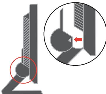
To će omogućiti pristup do vijaka koji učvršćuju postolje za monitor.
