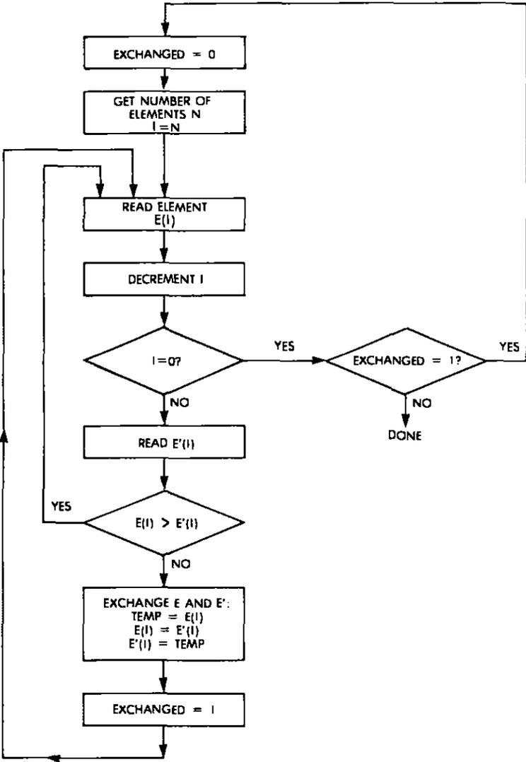
Fig. 8.7: Bubble-Sort Flowchart
